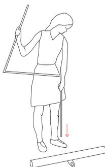
Die Klappstange aus der Kartusche nehmen und zusammenstecken. Unbedingt darauf achten, dass die Stange ganz in die Kartusche gesteckt wird. Sollte dies nicht erfolgen, kann die Standfestigkeit nicht garantiert werden und das Display kann umkippen.
