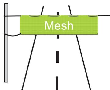
○ Sollten Sie keine andere Möglichkeit haben, empfehlen wir die Anbringung wie oben abgebildet (Abb. zeigt eine Werbeplane aus „Mesh“). Spannen Sie den Fahnenstoff mit Hilfe der oberen Ösenreihe und fixieren Sie diese dann z.B. mit einer Öse in der unteren Ecke. Diese Öse sollte ‚locker‘ sitzen und nur das Umschlagen des Stoffs bei Wind verhindern.
