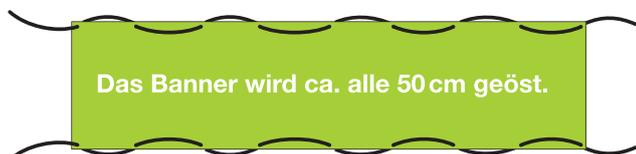
✓ Bitte benutzen Sie bei der Befestigung des Fahnenstoffs alle Ösen. Nur so kann eine lange und optimale Haltbarkeit gewährleistet werden.
