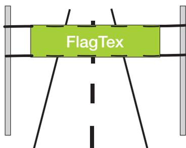
✗ Wir empfehlen, den Fahnenstoff nicht über eine größere Distanz ohne rückseitigen Schutz aufzuhängen. Der Stoff würde unter Umständen permanent der Windlast ausgesetzt sein. Für eine freihängende Anbringung empfehlen wir unser winddurchlässiges Planenmaterial „Mesh“.
