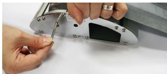
Nehmen Sie nun den Metallstift und stecken Sie ihn in die vorgesehene Öffnung. Diese befindet sich an der Seite von dem System. Justieren Sie das Banner so lange bis der Schlüssel komplett in die Kassette einrastet. Dazu müssen Sie den Druck eventuell wieder etwas in die Kartusche einrollen. Wenn kein Zug mehr besteht, ist der Aufrollmechanismus komplett blockiert.
