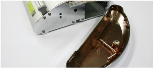
Lösen Sie den Metallstift, der sich in der Seitenkappe vom System befindet.
