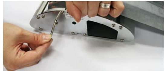
Nehmen Sie nun den Metallstift und stecken Sie ihn in die vorgesehene Öffnung. Diese befindet sich an der Seite von dem System. Justieren Sie das Banner so lange bis der Schlüssel komplett in die Kassette einrastet. Dazu müssen Sie den Druck eventuell wieder etwas in die Kartusche einrollen. Wenn kein Zug mehr besteht, ist der Aufrollmechanismus komplett blockiert.
