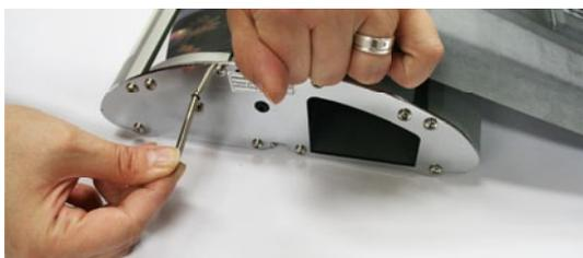
Sobald der Druck mit dem System verbunden ist, kann nun der Druck wieder eingerollt werden. Dabei hält eine Person wieder an der oberen Schiene den Druck fest, während die zweite Person am unteren Ende die Kartusche festhält und den Metallstift vorsichtig aus der Kartusche zieht, sodass der Aufrollmechanismus wieder aktiviert wird.
