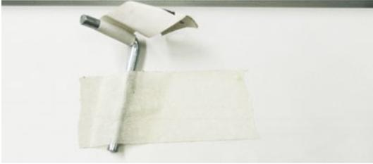
Lösen Sie den Metallstift, der sich unter der Kassette befindet (mit Kreppband fixiert).
